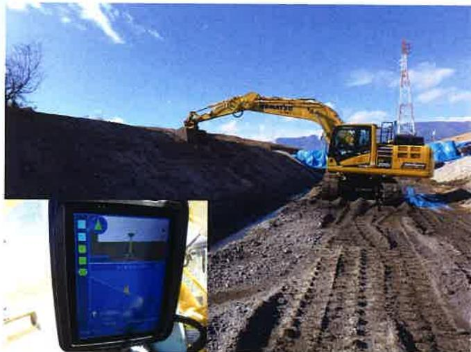
こちらの重機は【PC200i】という機械で、いわゆる『ICT』を活用した機械です。GNSSアンテナと基準局から得た刃先の位置情報、設計データをもとに、操作がセミオート化され、簡単に掘削(地盤を掘る)作業が行えます。
